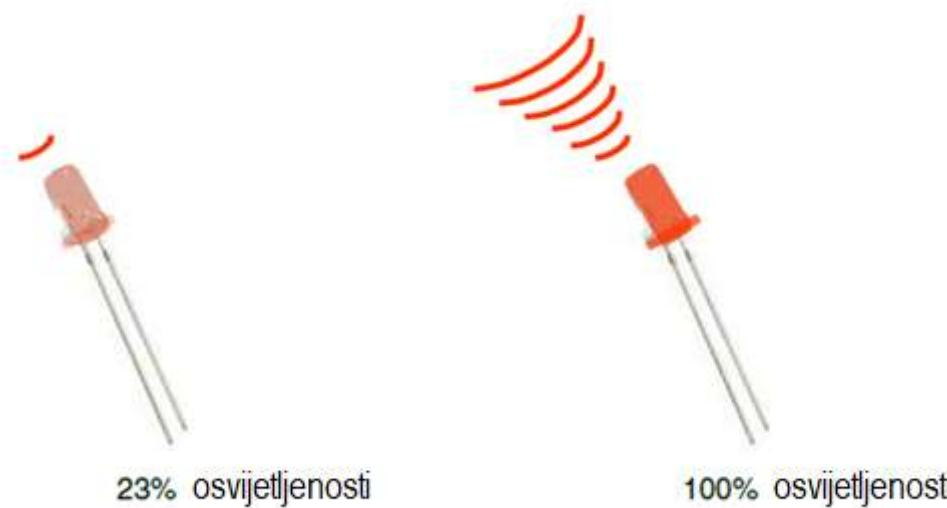
Analogni izlaz može biti simuliran upotrebom impulsno širinske modulacije (PWM)
